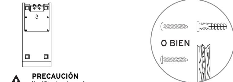
FIGURA 4 MONTAJE DE LOS ALTAVOCES SURROUND EN LA PARED
